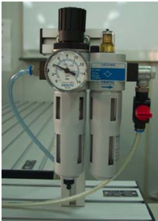
Foto de la unidad de mantenimiento
