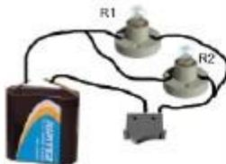
En el circuito de la figura sabemos que la pila es de 4'5V, y las lámparas son de 60Ω y 30Ω, respectivamente. Calcular:
