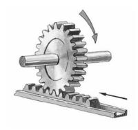
**Ejercicio 2.** Determina el desplazamiento de una cremallera que engrana con un piñón de 20 dientes y módulo 1,25 mm cuando éste da dos vueltas completas.
